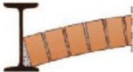
► Fig. 12 Tipi di solai con profilati e voltine.
